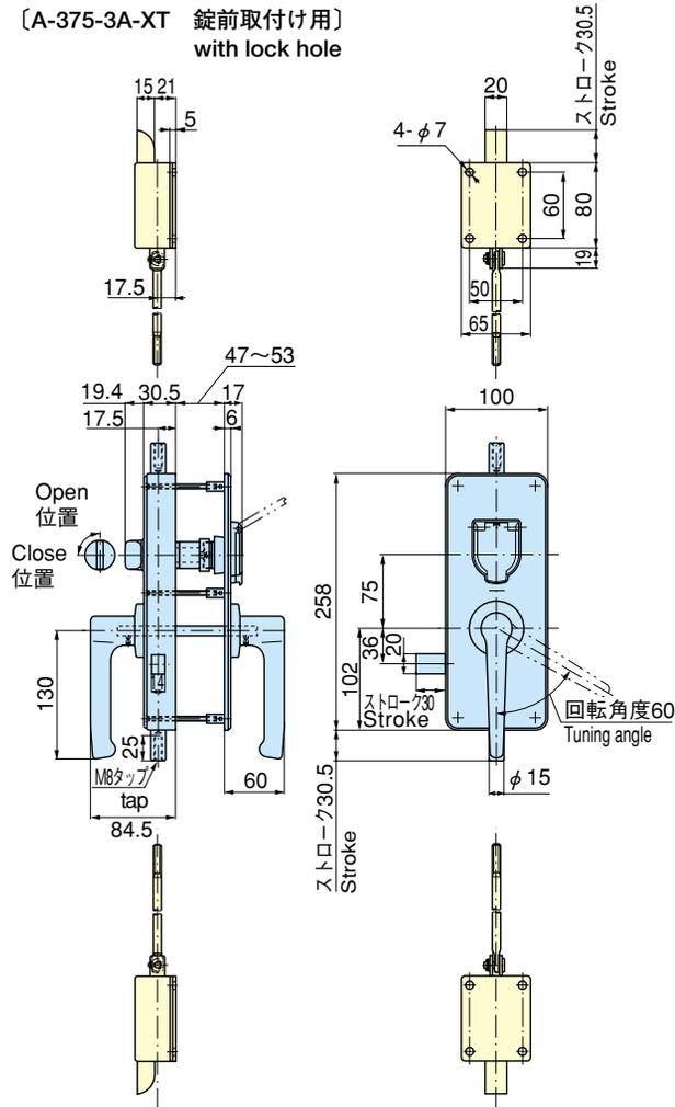
パネル穴明け寸法 Panel drilling dimensions
